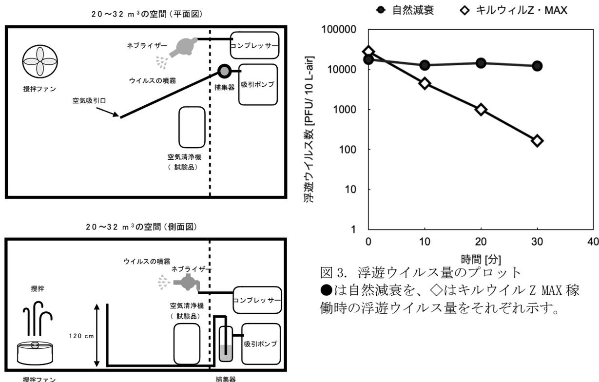
図2. 空気清浄機の浮遊ウイルス除去試験の実験概略図
